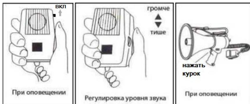
\* Включить микрофон можно переключателем сбоку. Так же включить микрофон можно, нажав на «курок» на рукоятке мегафона (кроме TSo-MGF15).
